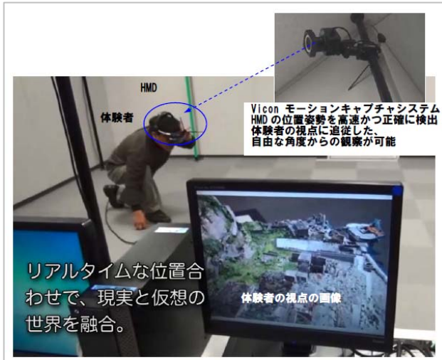
図 15 3Dモデルの中をMRで自由に体感している状況
