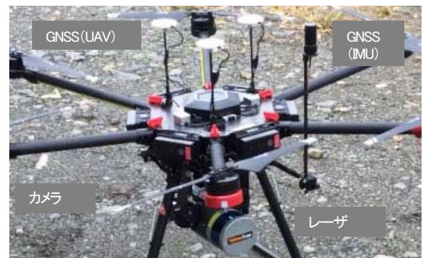
YellowScan (IMU レーザスキャナ)
