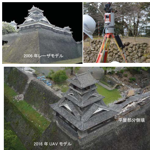
図 8 TLS, UAV (SFM) を用いた 3D モデル生成
