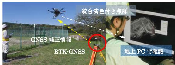
写真-1 UAV レーザ (リアルタイム空間情報取得システム)
