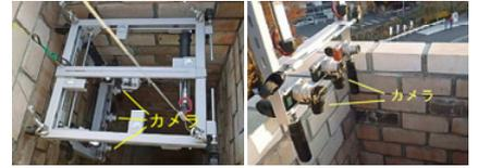
写真3 内壁用機材(右:炉接続部)
