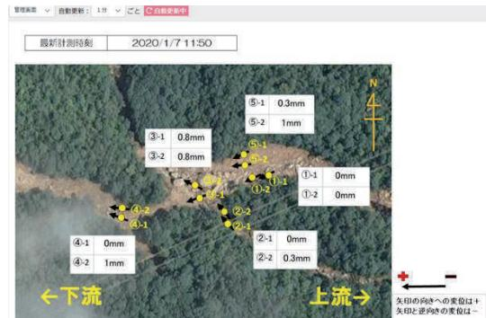
図-10 渓流内の地盤変位図の表示例
