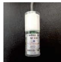
図-3 地盤変位の計測に採用した傾斜計
