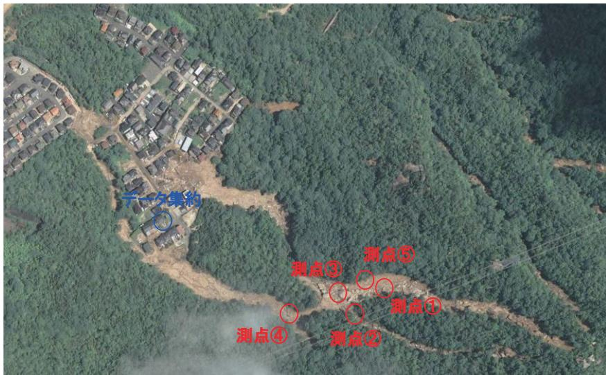
図-6 溪流内のセンサーの設置位置
