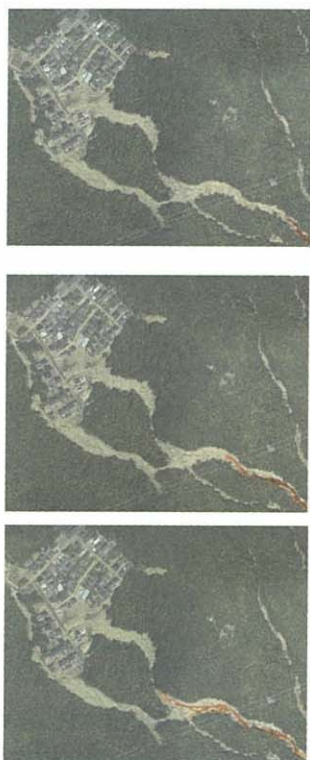
図-8 二次元土石流シミュレーションの結果例 (土石流を赤で表示, 上から下へ流出過程を示す. 写真は国土地理院による)
