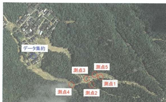
図-10 熊野町川角大原ハイツの溪流におけるセンサー・送信機と受信機の設置位置 (写真は国土地理院による)
