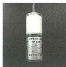
図-2 地盤変位の計測に用いた傾斜計とその仕様
