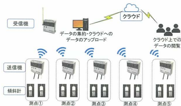
図-4 クラウドを用いた計測システム
