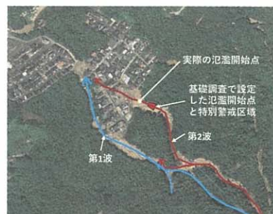
図-6 熊野町大原ハイツの土石流（写真：平成 30 年 7 月西日本豪雨に関する情報，国土地理院）
