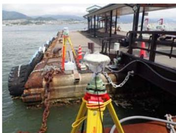
図-5 RTK-GNSS 測量器 (アンテナ) 設置状況
