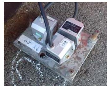
図-3 サーボ型加速度計設置状況
