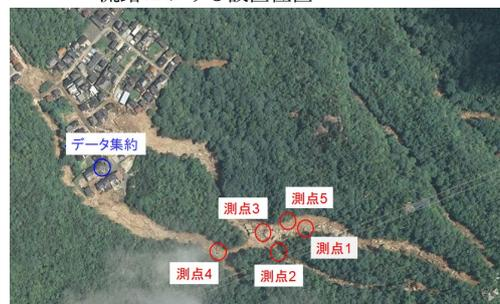
図2 溪流内に設置した10か所の測点
