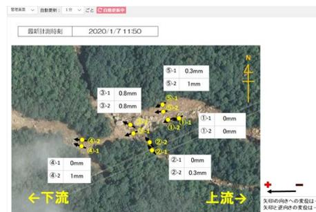
図3 溪流の地盤変位のモニタリング画面
