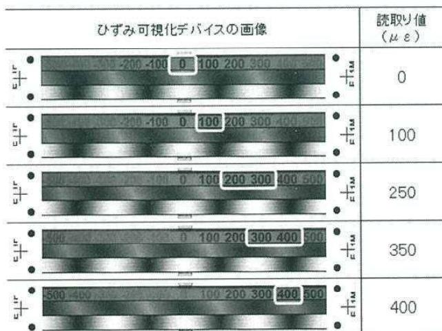
第3図 可視化部分のひずみ値の変化
