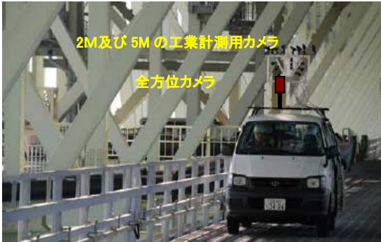
図4 10km/hで走行しながらの撮影状況
