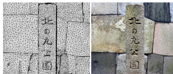
図-4 SfM モデルの TIN とテクスチャ
