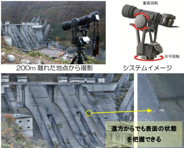
図 3. ギガピクセル画像撮影システム
