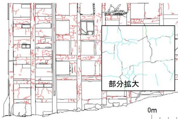
図 23 ひび割れ幅毎にレイヤー分類した
