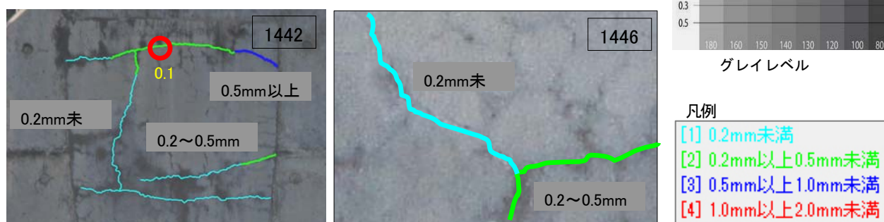
図26 擬似オルソ画像によるひび割れ幅算定結果
