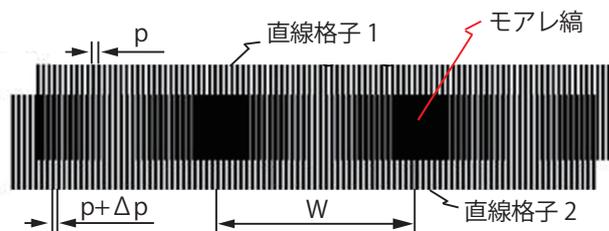
ピッチの異なる直線格子を生成した 2 枚のプレートを重ねることで発生するモアレ縞の原理を用いています。直線格子 1 のピッチを  $p$ 、直線格子 2 のピッチを  $p+\Delta p$  とすると、モアレ縞のピッチ  $W$  は、 $((p+\Delta p)/\Delta p) \cdot p$  で表されます。式より、直線格子 1 がピッチ  $p$  ほど移動すると、視覚的に  $(p+\Delta p)/\Delta p$  倍に拡大表示され、モアレ縞は  $W$  ほど移動します。この原理によって、2 枚のプレートの相対的な微小変位を視覚的に拡大表示して検出します。
