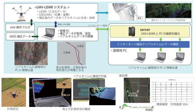
UAVに搭載された PC で RTK (リアルタイムキネマティック) 手法で解析・処理した色付き点群を、無線 LAN を経由した地上の PC で 確認が可能。地上から点群の平面/鳥瞰表示などのコマンドを送信することで、それに応じた点群取得状況の確認が地上にて可能。 UAV 搭載の IMU は、航空機 LiDAR とほぼ同程度の精度を有していおり高精度なマッピングデータ提供が可能。
