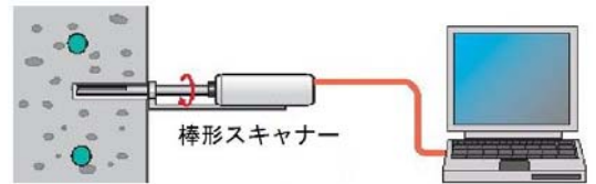
図-5 棒形スキャナーによる調査の概要
