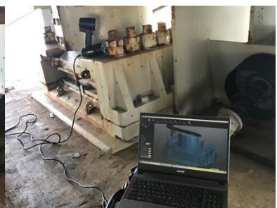
ハンディタイプ高精度スキャナ計測 (Go Scan 3D)
