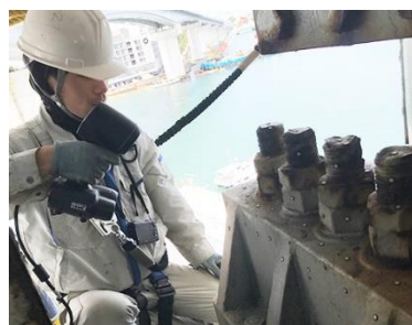
ハンディタイプ高精度スキャナ計測 (Go Scan 3D)
