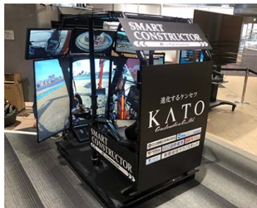
マルチコックピットによる複数建設機械の遠隔操縦 (株式会社 加藤組)
