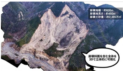
土砂災害に備える先進技術～河道閉塞(天然ダム)の調査におけるドローン技術の活用 (中電技術コンサルタント 株式会社)
